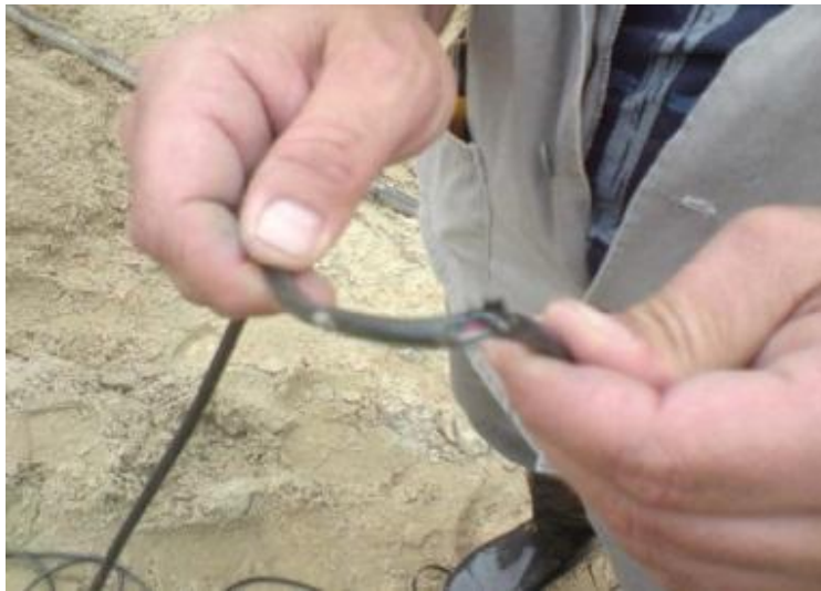
Figura 9. Detalhe do cabo do strain gage danificado.
