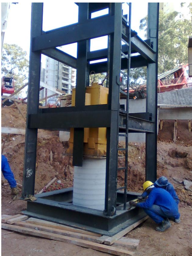
Figura 1. Martelo de Queda Livre Acoplado a Torre
