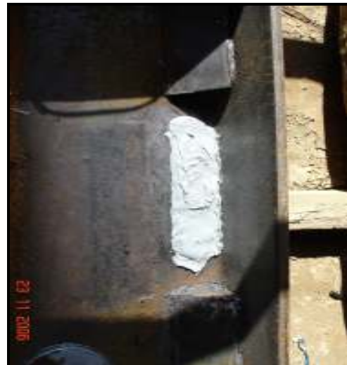
Figura 07 – Strain Gages protegidos com uma resina
