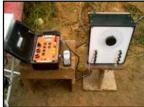
Figura 19 –Caixa seletora para leituras dos “Strain Gages”.
